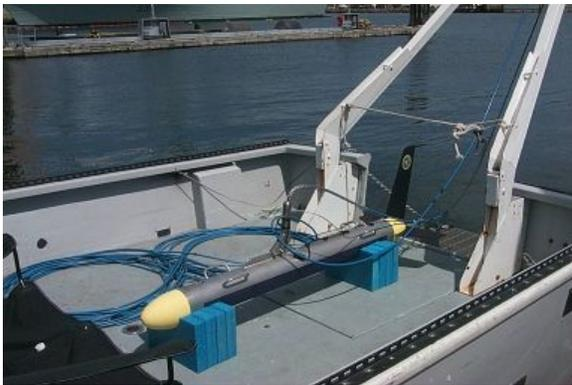
Figure 1a L3-Klein 5500 Sidescan Sonar
